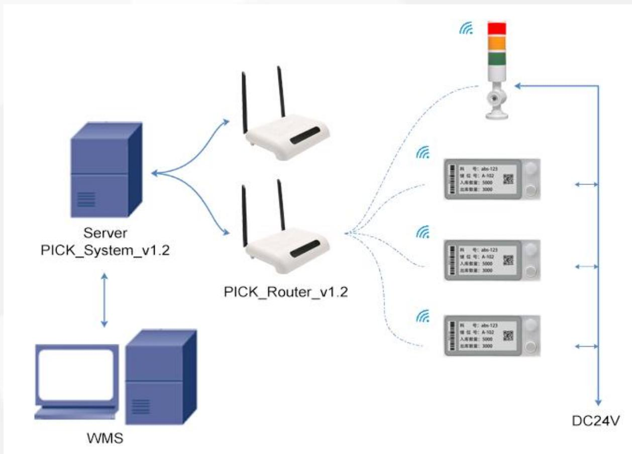
电子标签拣货系统就是通过PC机或扫描枪发送指令，通过路由器转发，控制电子标签上的LED灯或屏幕指引拣货人员准确，快速地到指定的位置拣取相应的货物。
