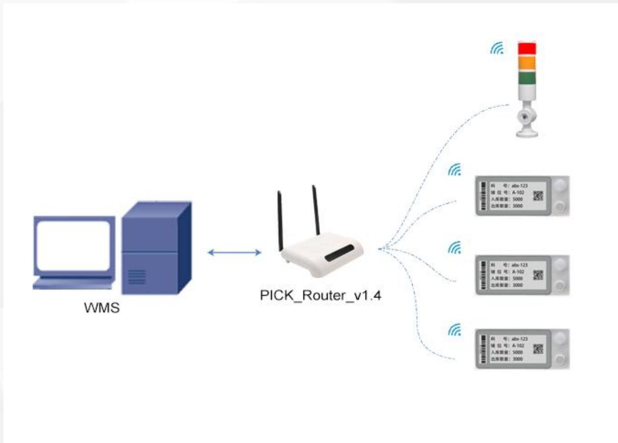
注：V1.4版本的基站内置服务器程序，用户只用向此基站发送操作指令就可实现数据传递，使用更简单。
