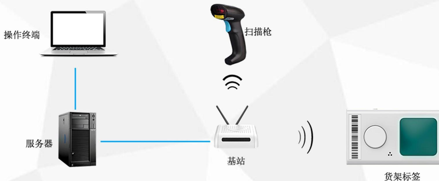
电子标签拣货系统就是通过PC机或扫描枪发送指令，通过路由器转发，控制电子标签上的LED灯或屏幕指引拣货人员准确，快速地到指定的位置拣取相应的货物。
